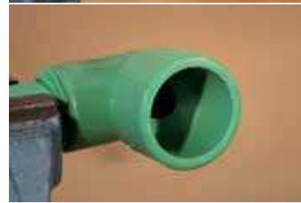
Operare la fusione del nuovo elemento art. 69314 con matrice Ø 32 mm.
