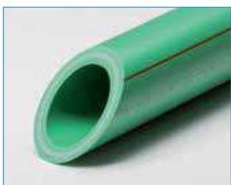
Tubi in PP-RCT e PP-R 80 Super fibrorinforzato, da assemblare mediante polifusione con raccordi a saldare e raccordi filettati. Per posa esterna e/o sotto traccia.
