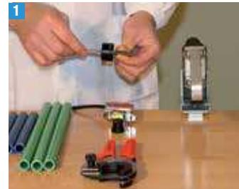
Montare e fissare le matrici al polifusore, dopo aver verificato che le matrici siano in perfetto stato: matrici con teflonatura rovinata, con superficie deformata a causa di urti o con presenza di materiale di saldatura depositato non rimovibile vanno sostituite.
