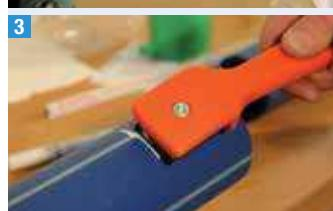
Raschiare le testate di tubi per almeno 0,1 mm su tubazioni fino a Ø 63 mm e almeno 0,2 mm su diametri superiori.
